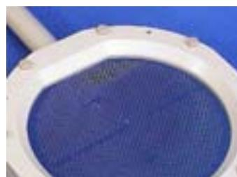
Sistem A.M.M.T pentru corodare placante de Si de 4 inch cu sursa programabila si cu software dedicat pentru inregistrarea profilului curent-timp.
